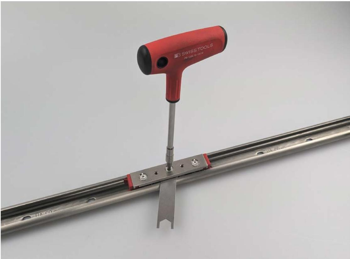
7. Bewegen Sie nun den Läufer in der gesamten Schiene um die Vorspannung zu prüfen. Die Rollen müssen sich drehen (kein Schieben) und jederzeit Kontakt mit der Laufbahn aufweisen. Der Läufer soll ohne ruckartige Bewegungen flüssig und ohne grossen Kraftaufwand bewegt werden können. Die Einstellung der Vorspannung hängt vom Einsatzzweck ab und entsprechend können die Werte variieren.
