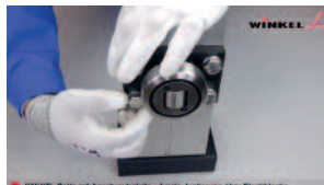
WINKEL-Folie mit Anschraubblech - Axiale Justierung über Stahlbleche
