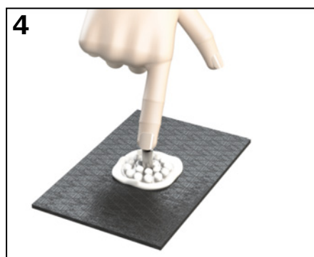
4 Den Befestiger andrücken, bis etwas Kleber durch die Perforierung fließt. Press the fastener in order to have some adhesive coming out from the holes of the base plate.
