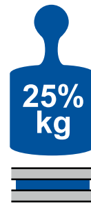
Montage horizontal = 25% de la charge mentionnée
